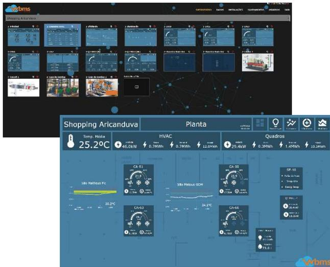
Todos os dados coletados, controlados e visualizados no supervisório Wbms, são armazenados de forma segura no portal da Wbms e podem ser analisados a partir de dispositivos que estejam conectados à internet. Apenas os profissionais com privilégios específicos terão acesso a estes dados.
